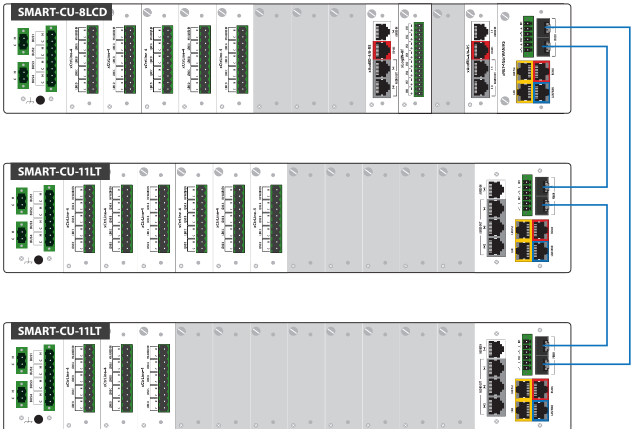
Rysunek 74. Połączenie jednostek kontroli w topologii Ring (światłowód)
