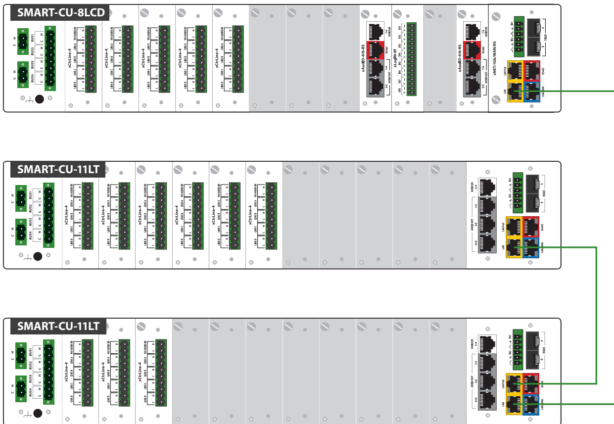
Rysunek 73. Przykładowe połączenie jednostek kontroli w topologii Daisy Chain
